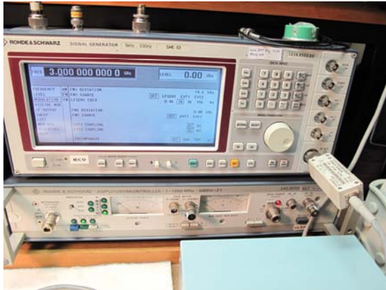
Abbildung 8: Test des reparierten URV5-Z5 Messkopfes
