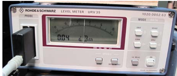
Abbildung 8: Test des reparierten URV5-Z5 Messkopfes
