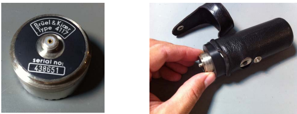
Abbildung 4: Mikrofonkapsel (Typ 4117) einzeln (links) sowie im 94dB-Kalibrator (rechts)
