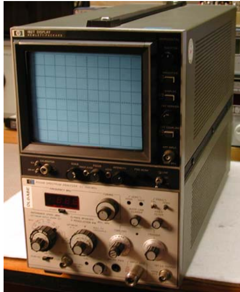
Abbildung 2: HP181T Mainframe mit Analyzer-Einschub HP8558B
