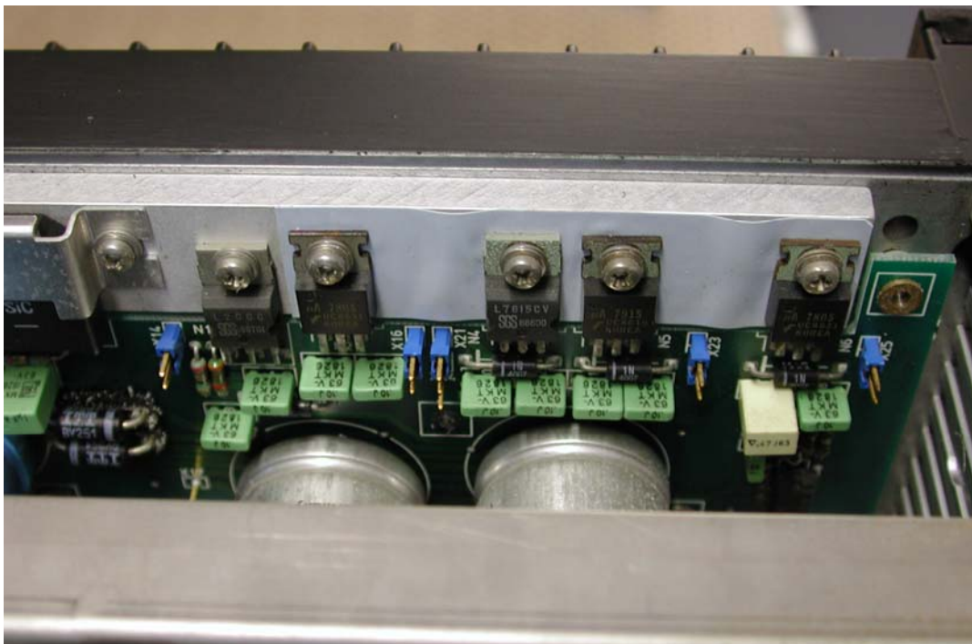
Netzteil-Baugruppe, am Chassis verschraubt
